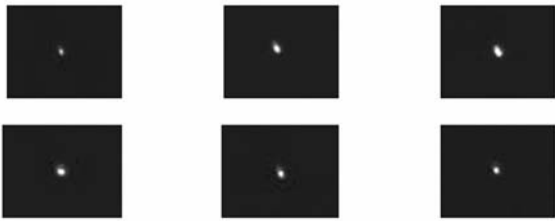
图 12 CCD 检视下光强闪烁对光斑能量的影响
